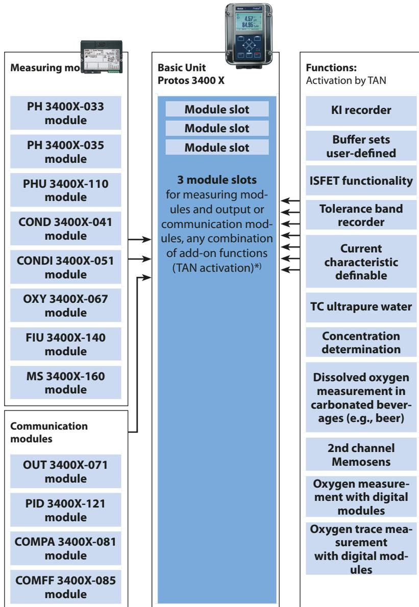
\*) 2 module slots when using 1 x FIU module.
