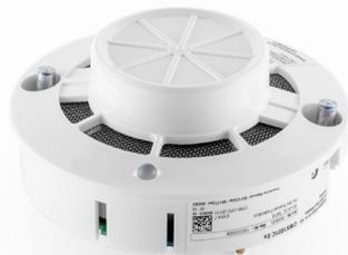
Optischer Rauchmelder mit eigensicherer Elektronik für die Ex Zone 1 in Grenzwerttechnik. Robuster Rauchmelder mit automatischer Ruhewertnachführung, auch für den Einsatz in industriellen Bereichen. Betrieb in explosionsgefährdeten Bereichen mit Anschluss an die BMZ über das TCM und eine Zenerbarriere (Artikel Nr.: 33084). Die Barriere ist nach den Herstellerangaben und außerhalb des Ex-Bereiches zu installieren.
